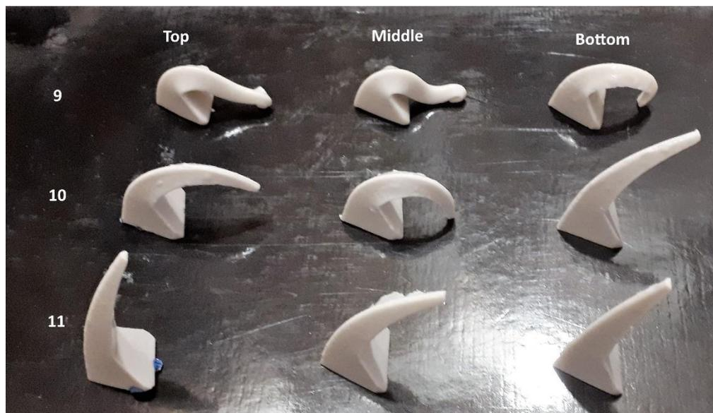
Ces cônes correspondent en fait à une cuisson à **1250°** (courbe ci-dessous). Si on prend le tableau Orton au pied de la lettre (ou plutôt du chiffre), cela devrait être cône 8. MAIS ... Je mets 2h30 entre 1050 et 1250 (donc assez long), et j'ai un palier de 30mn. Cela augmente la chaleur d'environ 2 cônes *dans mon four*.
